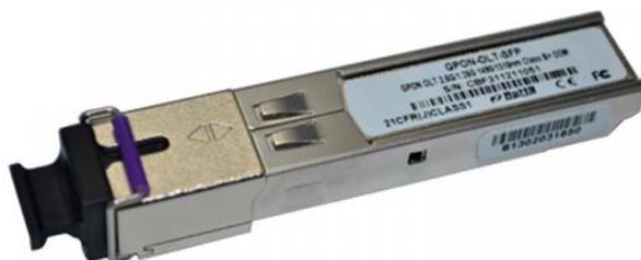
**Módulo OLT SFP, estándar Clase C ++, enlace descendente 2.5G / enlace ascendente 1.25G, longitud de onda TX1490nm, longitud de onda RX 1310nm, interfaz SC**
